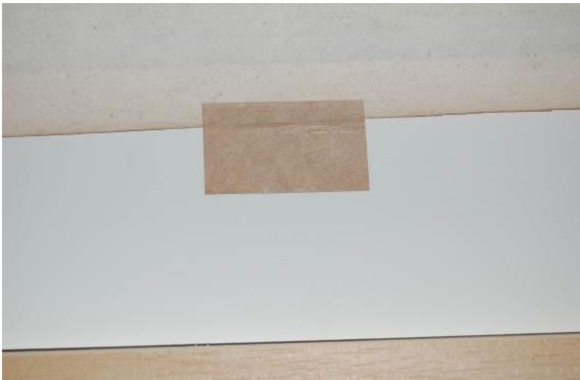
2. foto. Az enyves ragasztószalag a rögzítési ponton
